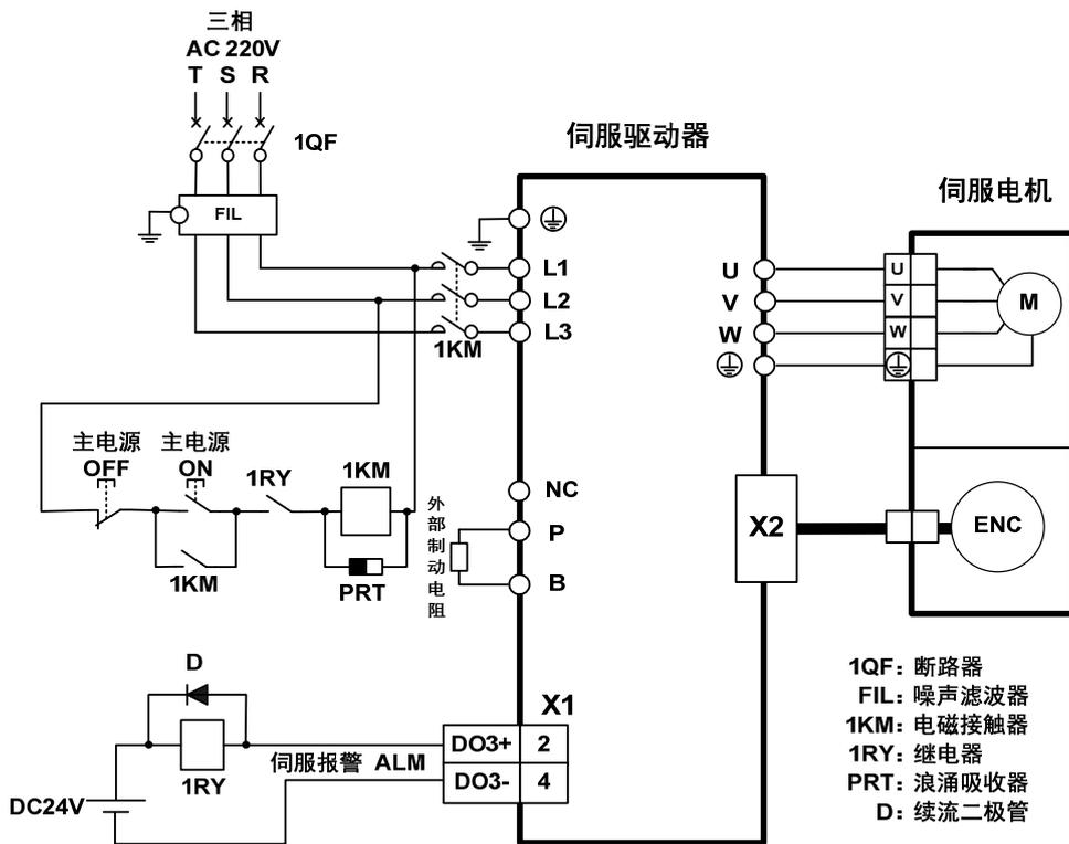
注：TL55 无内部制动电阻，需连接外部制动电阻使用。
