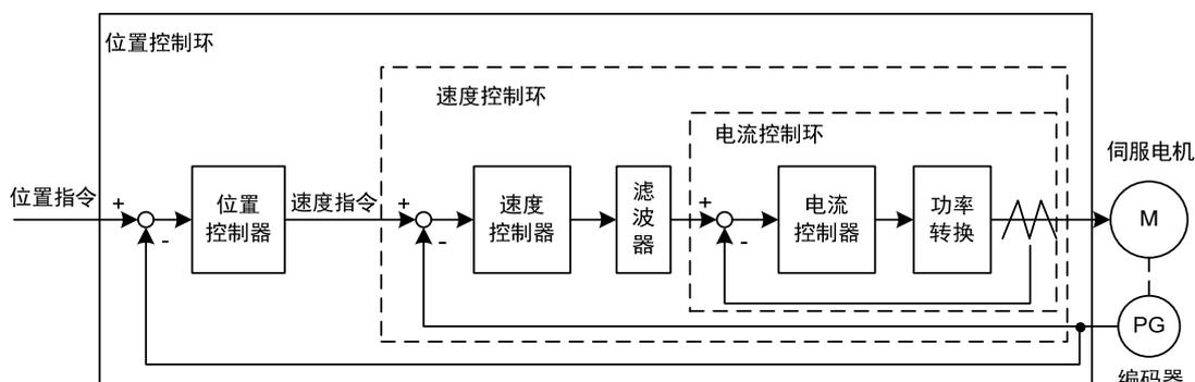
理论上，内层的控制回路频宽一定要高于外层，否则整个控制系统会不稳定而造成振动或是响应不佳，因此这三个控制回路频宽的关系如下：
