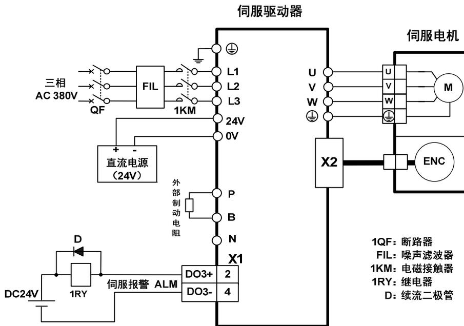
注：TH90、TH110、TH150 无内部制动电阻，需连接外部制动电阻使用。
