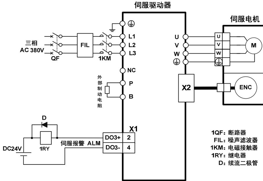
注：TH50、TH75 无内部制动电阻，需连接外部制动电阻使用。
