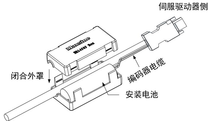
**注意：**请在伺服驱动器侧设置电池单元。电池单元请设置在伺服驱动器的任意一侧。
