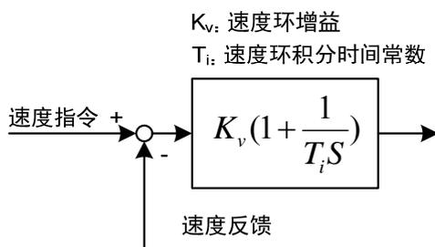
P018 可选择速度控制器结构，0 为 IP 调节器，100 为 PI 调节器，1~99 为 PDFF 调节器。P018 参数值偏大则系统具有高频率响应，参数值偏小则系统具有高刚度（抵抗偏差能力），中等数值兼顾频率响应和刚度。
