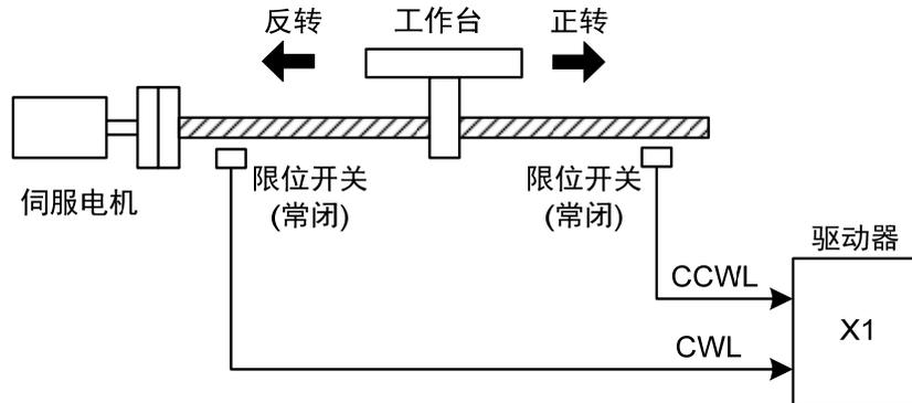
限位开关建议使用常闭接点，在安全范围内为闭合，超程为断开。连接到正转驱动禁止（CCWL）和反转驱动禁止（CWL），通过参数 P097 也可设置为使用与忽略。设置为使用，则必须接入限位信号；设置为忽略，则不需要该信号。参数缺省值是 CCWL 和 CWL 都忽略，如果需要使用，必须修改参数 P097。即使在超程状态下，仍允许通过输入反向指令退出超程状态。
