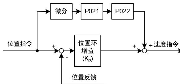
前馈能降低位置环控制的相位滞后，可减小位置控制时的位置跟踪误差以及更短的定位时间。前馈量增大，位置控制跟踪误差减小，但过大会使系统不稳定、超调。
