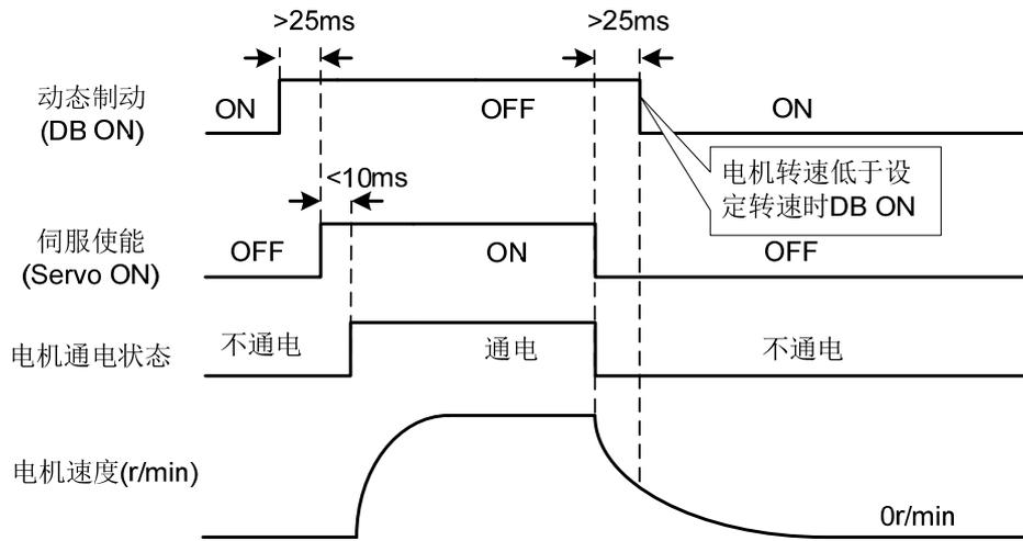
**注意：**型号TL04/TL08/TL10自带了板载的动态制动继电器，仅支持内部动态制动功能，受P083控制，无外部动态制动功能；其他型号没有板载动态制动继电器，只有外部动态制动器功能。
